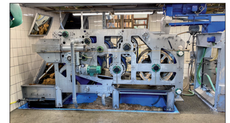
Kundenmoster Bruno Wittwer kippt die Äpfel in den Silo, wo die Früchte zuerst gewaschen werden und nachher zur Obstmühle gelangen. Mit der Bandpresse erfolgt der eigentliche Pressvorgang.
